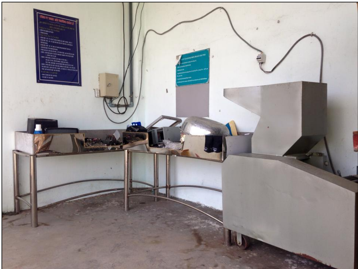
Hình. Hệ thống sơ chế thiết bị điện tử (công suất 100 kg/h)
