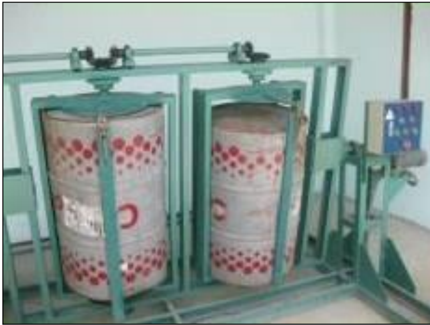
Hình. Hệ thống súc rửa thùng phuy (công suất 100 kg/h)
