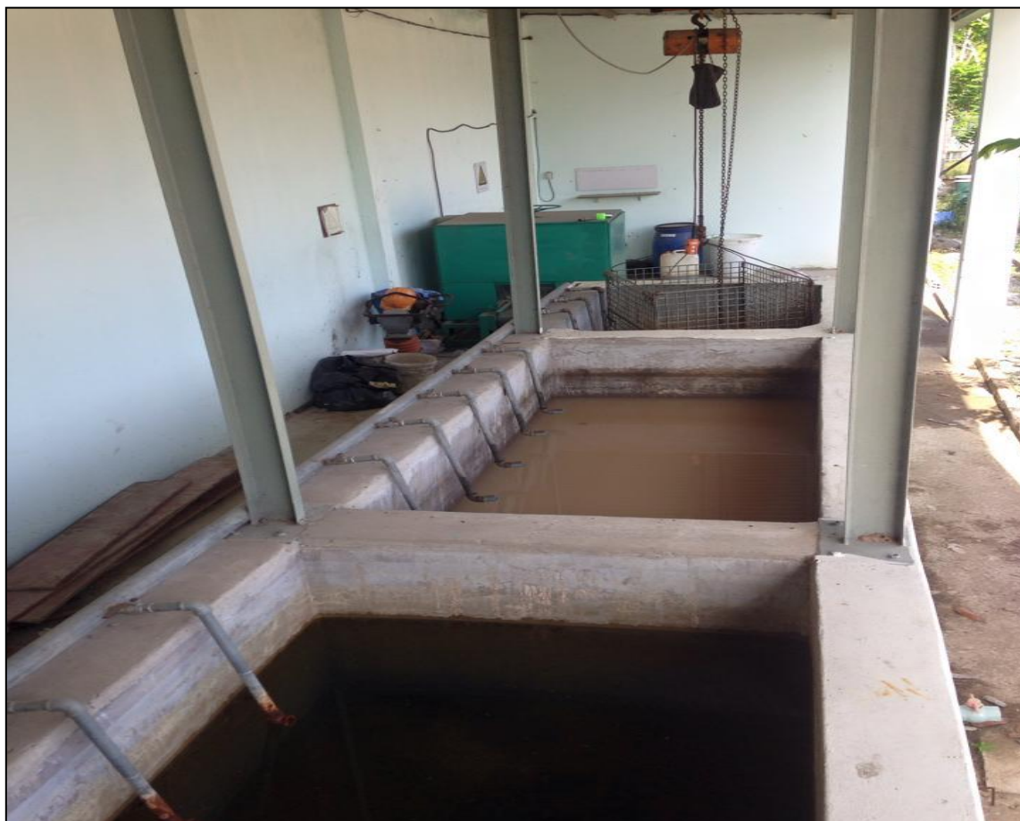
Hình. Hệ thống tẩy rửa phế liệu dính CTNH (công suất 630 kg/h)
