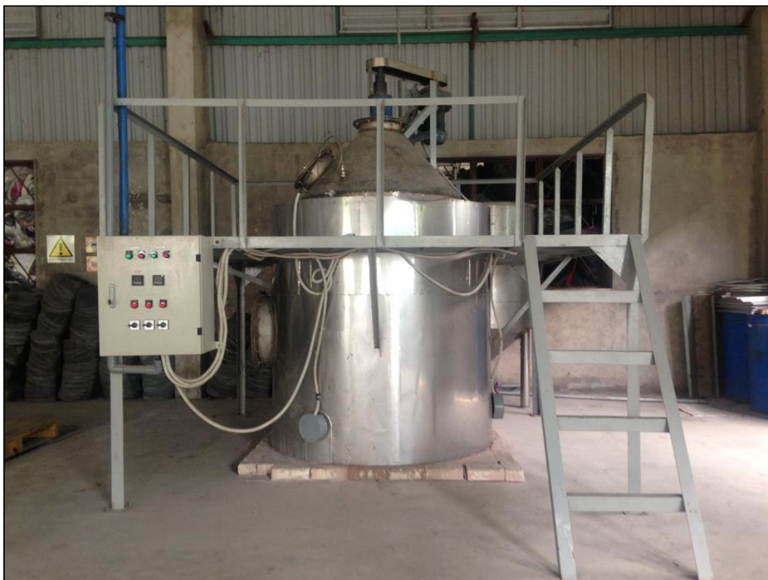
Hình. Hệ thống tái chế dung môi (công suất 190 kg/h)
