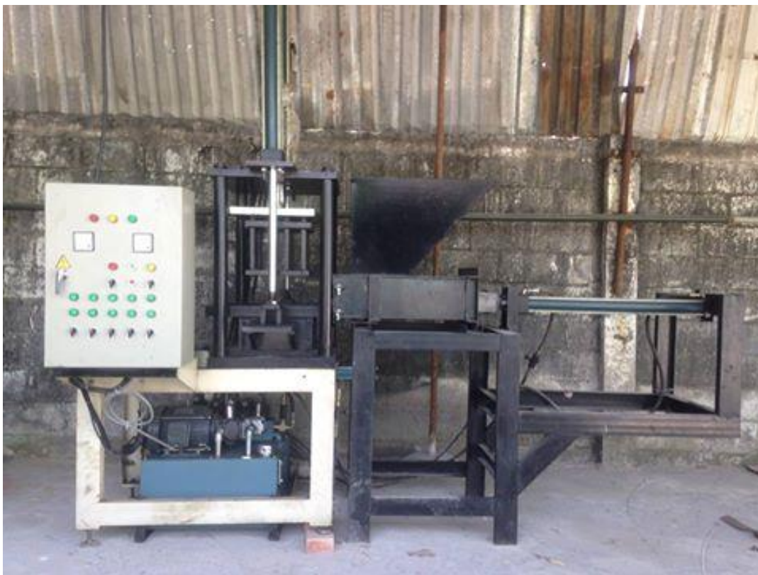
Hình. Hệ thống ổn định hóa rắn (công suất 150 kg/h)
