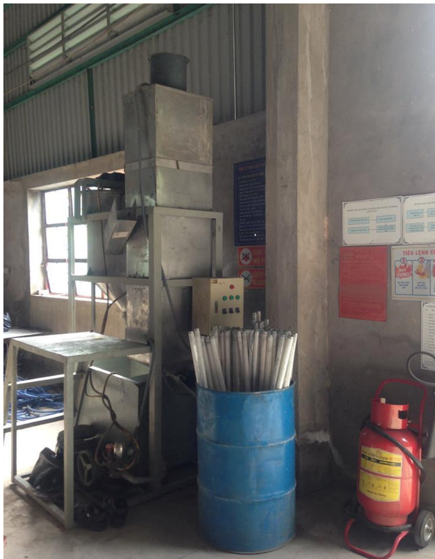
Hình. Hệ thống xử lý bóng đèn huỳnh quang (công suất 10 kg/h)
