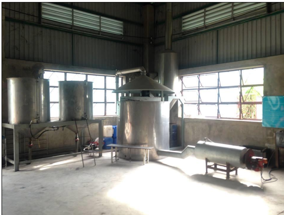
Hình. Hệ thống tái chế dầu nhớt (công suất 100kg/h)
